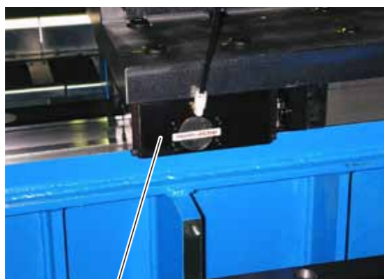
钻孔加工机的驱动部 (机架)的松动防止装置
