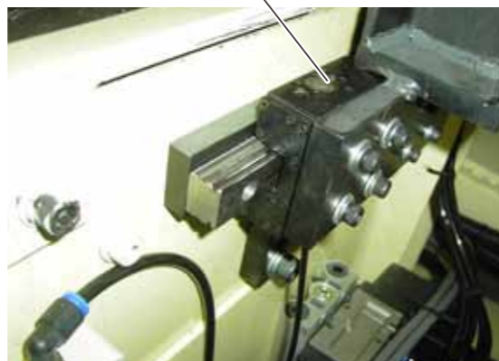
切断加工机 制动装置的保持
