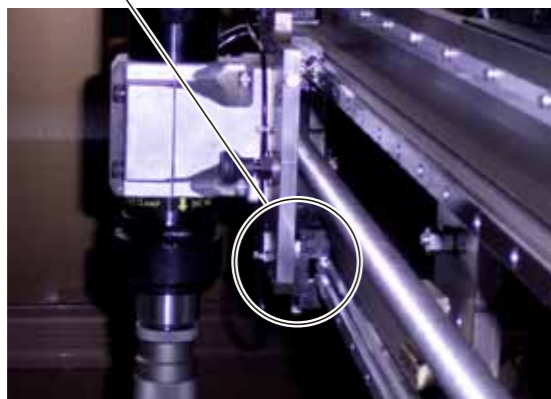
钻孔加工机卡盘部 (手动)的定位
